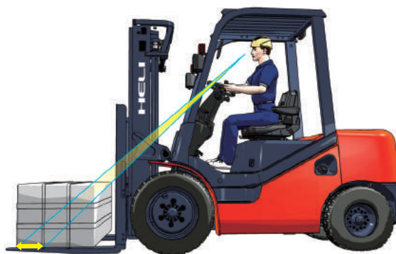
■ Większa o 20 mm widoczność końców wideł i ładunku
