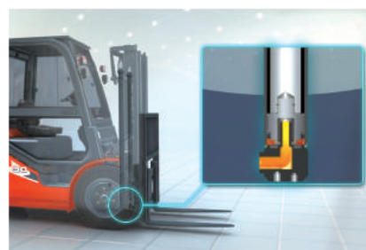
■ Zawór dławiący z układzie hydraulicznym
