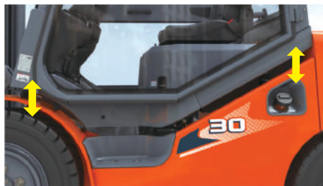
■ Klatka operatora jest połączona z ramą wózka za pomocą wibroizolatorów
